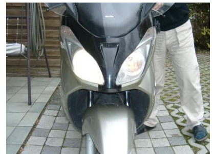
Bild: 3 Links die OSRAM Night-Breaker-H11, rechts die normale H11-Halogenlampe
